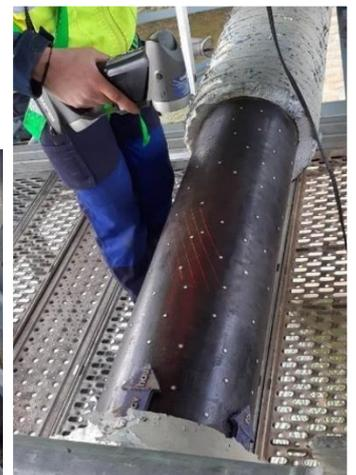
Le diagnostic permet de mettre en évidence les variations d'épaisseur sur des portions caractéristiques de la canalisation étudiée. A l'issue du diagnostic, le bureau d'étude propose une estimation de la durée de vie restante permettant au service de mieux prioriser son plan de renouvellement des canalisations.
