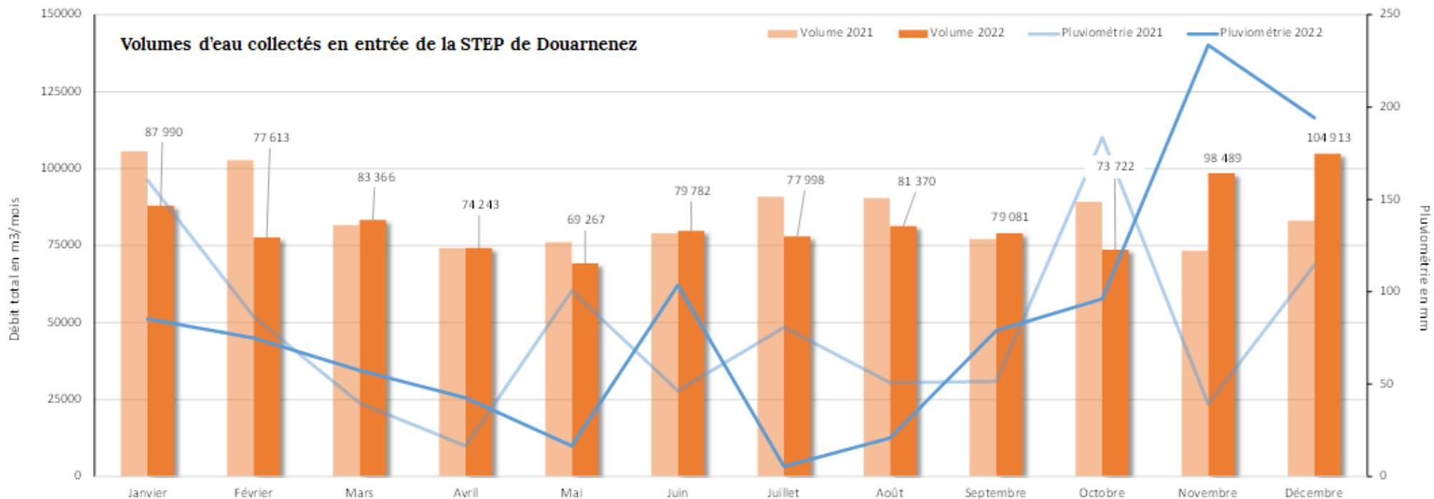
Figure 51 : Répartition des volumes mesurés en entrée de STEP
