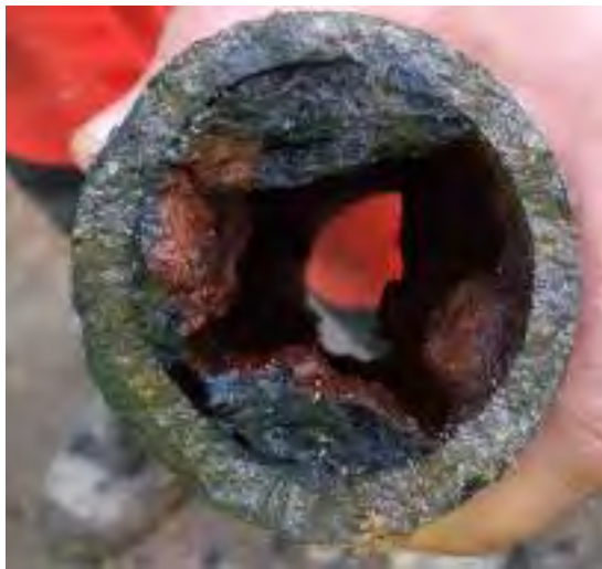
Figure 34 : Obturation partielle de la conduite AEP rue Couëdic par des dépôts métalliques et travaux de renouvellement
