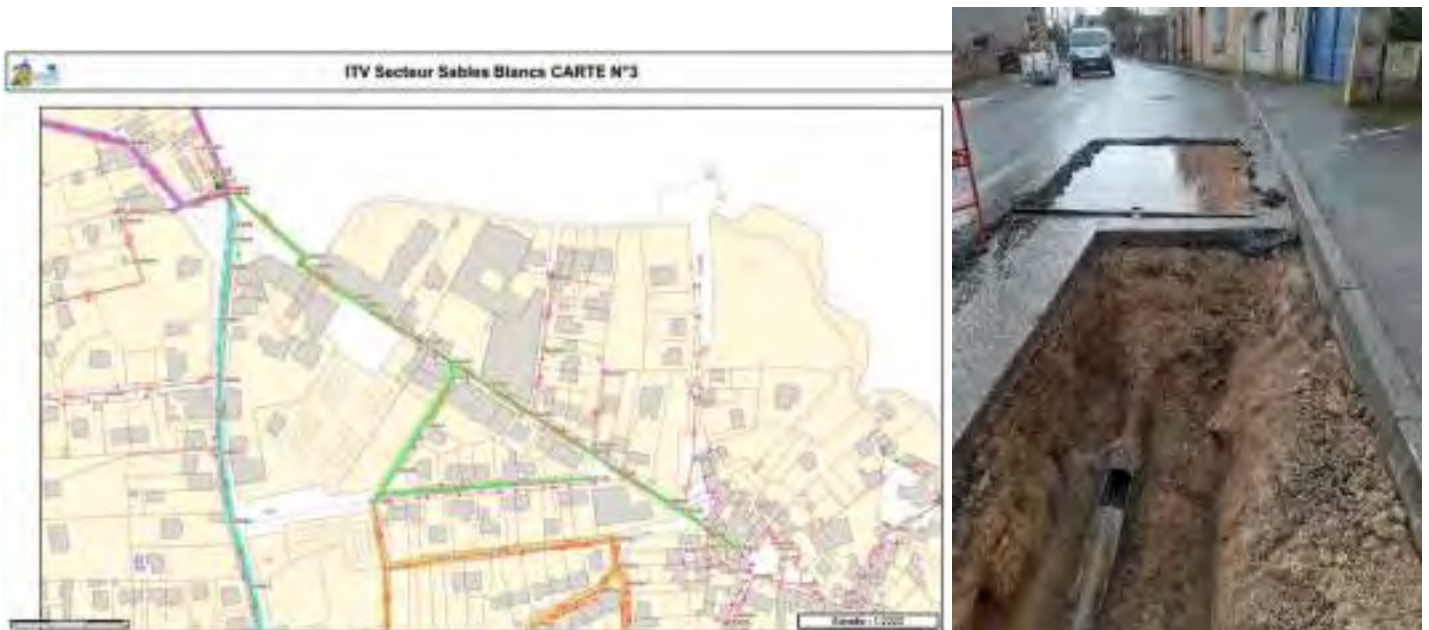
Figure 46 : Investigations sur les canalisations (plan des ITV et prélèvement pour l'analyse macrographique)
